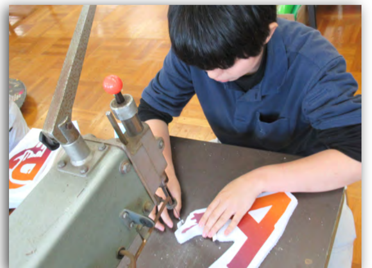
糸ノコを使用してカルプ切文字の練習をしています。
